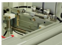
Carro de revestimiento con control neumático
