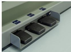
Pedal para el travesaño y los tensores
