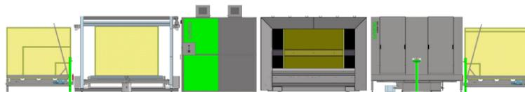
Lavage, dégravage, séchage, enduction, séchage, illustration CtS et développement IN-LINE avec module de chargement/de décharge-
